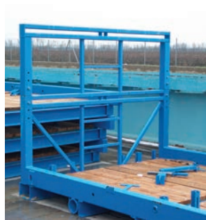
19. Szállítókeret – alacsony homlokfal magasítással
