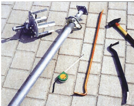
14. Födém építéséhez szükséges eszközök
