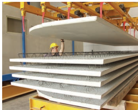
3. Leier mesterpanel (LMP) mozgatása a gyártás során
