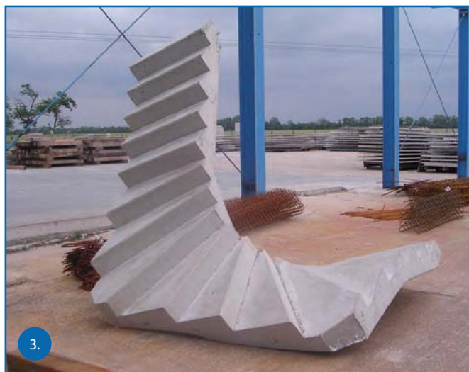
3 karú, méretre gyártott beton-lépcsőelem
