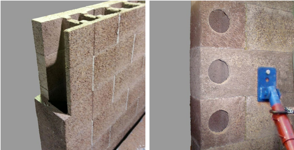
4.14. ábra A kéregfal elemek kapcsolódásához szükséges módosításokat még az üzemi előregyártás során elkészítik
