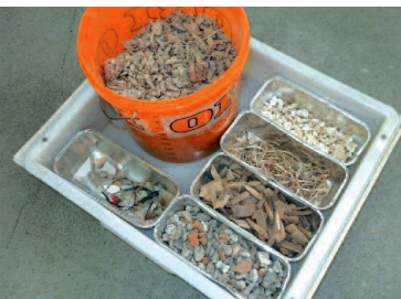
3.14b. ábra Fabeton zsaluzóelemes szerkezetek bontása és az anyagok szét- választása különböző frakciókra, 3-4. fázis
