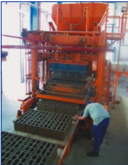
Termelés a betonelemgyártó OMAG gépsorral Produktion mit der Brettfertigungsanlage OMAG Praca na maszynie do produkcji kostki brukowej na blatach drewnianych OMAG
